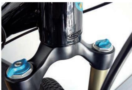
Dans le cas d'une fourche ou d'un amortisseur à ressorts et/ou élastomères, une molette de réglage de précontrainte peut vous permettre d'adapter les réglages à votre poids et votre style de pilotage :
