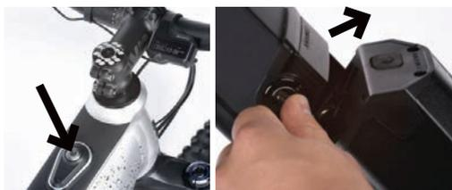
En fonction des modèles, appuyer sur le bouton marche / arrêt sur le cadre **ou** sur les boutons marche / arrêt de la batterie et de l'afficheur.
