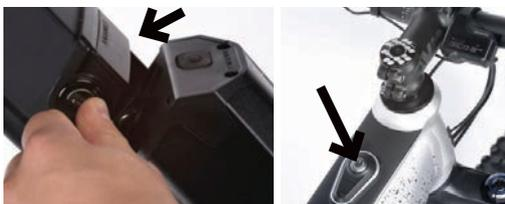
En fonction des modèles, appuyer sur le bouton marche / arrêt sur le cadre **ou** sur les boutons marche / arrêt de la batterie et de l'afficheur.
