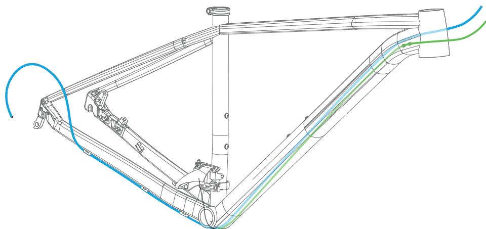
FRONT AND REAR DERAILLEUR AND BRAKE ON CHAINSTAYS
