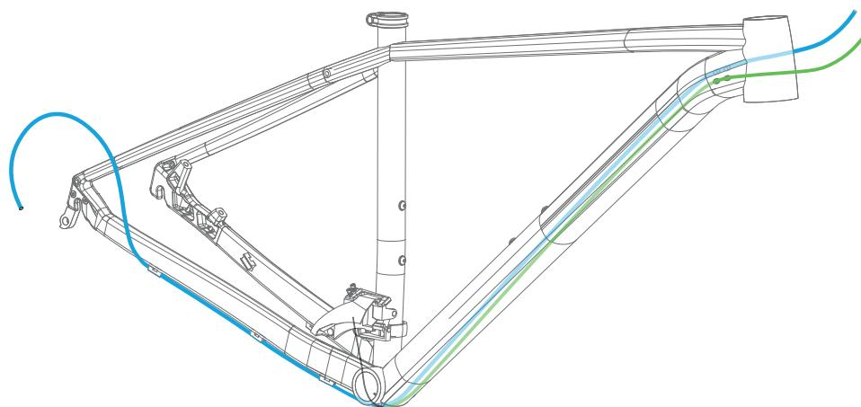
CABLEADO DE CAMBIO, DESVIADOR Y FRENO EN VAINAS
