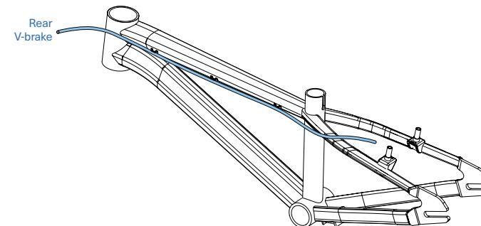
MX20 / MX24 BRAKE AND REAR DERAILLEUR CABLE ROUTING
