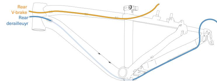
MX20 / MX24 TEAM DISC 2024- BRAKES AND REAR DERALLEUR CABLE ROUNTING
