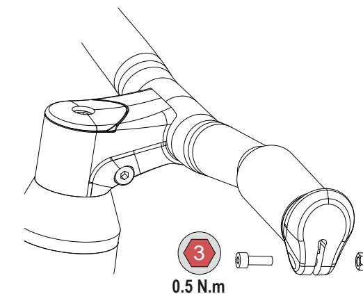
2. Los tapones deben posicionarse en el manillar de manera que la ranura quede orientada hacia abajo.
