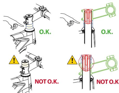
**!** Nunca instalas separadores de dirección por encima de la potencia. Colocar separadores por encima de la potencia, especialmente en horquillas con el tubo de dirección de carbono, puede provocar que el expansor de dirección dentro del tubo de la horquilla quede posicionado por encima del límite inferior de la potencia, lo que puede forzar los materiales más allá del uso para los que fueron diseñados, potencialmente provocando accidentes y lesiones graves.
