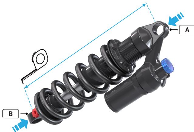
Le sag correspond au taux de compression de l'amortisseur sous le poids du cycliste et il se mesure en calculant la différence de distance entre l'œillet avant (A) et l'œillet arrière (B) de l'amortisseur, avant et après que le poids du cycliste s'exerce normalement sur le vélo sans le faire rebondir.
