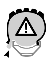
Figure 27. Chambre à air coincée entre le pneu et la jante
