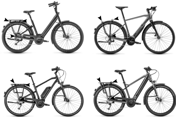
Figure 35. Points de fixation sur les différents porte-bagages représentés par les flèches noires
