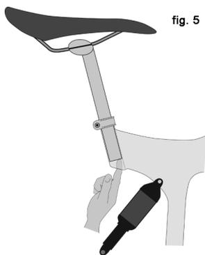
fig. 5 ci-dessus, la tige de selle peut se briser, ce qui le contrôle du vélo et une chute.
